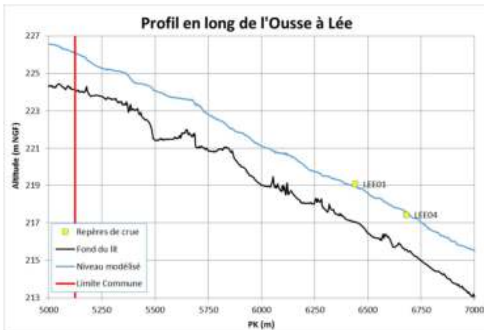
Figure 23 : Profil en long de calage du modèle sur la crue de janvier 2014 à Lée
